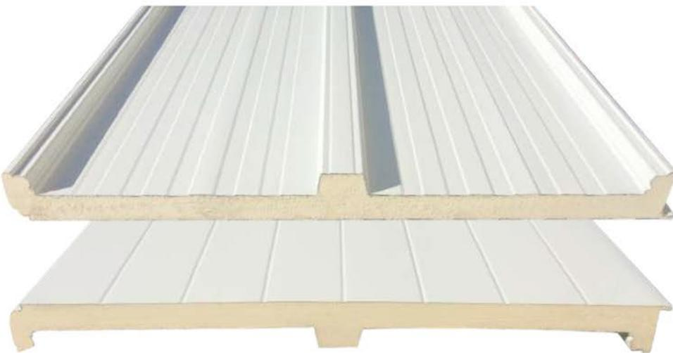
Panel cubierta sándwich de 50mm de espesor, 3 grecas con tornillería oculta. Su diseño con sistema machiembrado y con una colocación de tapajuntas le otorgan el máximo grado de estanqueidad y durabilidad de las juntas.
