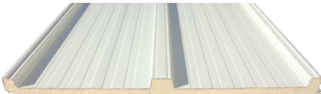
Panel cubierta sándwich de 30mm de espesor, a 3 grecas con tornillería oculta. Su diseño con sistema machiembrado y con una colocación de tapajuntas le otorgan el máximo grado de estanqueidad y durabilidad de las juntas.
