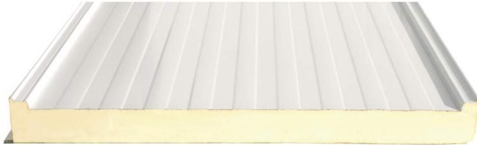
El panel sándwich para cubierta a **2 grecas** con tornillería oculta posee un sistema machihembrado y con colocación de tapajuntas que le otorgan el máximo grado de estanqueidad y durabilidad de las juntas. Las caras exteriores están fabricadas en acero prelacado mientras que el núcleo del panel es de espuma PUR lo que le otorga clasificación al fuego **Bs2d0**.
